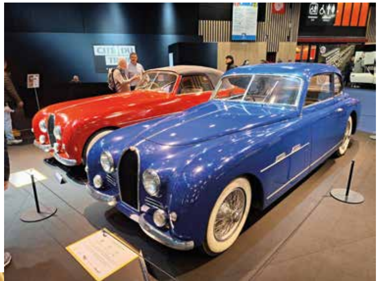
Bugatti Type 101 C „Coach bleu“ (1951), karoserie Gangloff Colmar. Řadový osmiválec 3,3 l/150 k, hmotnost 1700 kg. Vůz byl představen na pařížském autosalonu v roce 1951, následně i v Ženevě o rok později. Dochován v původním stavu s autentickým průkazem původu. Za ním červený vůz téhož typu, ovšem s otevřenou karosérií.
