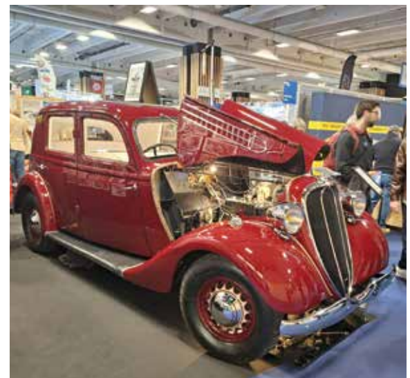
Chenard & Walcker Aigle 20 Type 22 R (1937). Čtyřválcový motor 2,2 l/54 k při 3000 min -1 , daňový výkon 12 CV. Čtyřstupňová převodovka s volnoběhem, brzdy ovládané lanky. Vůz po kompletní renovaci mechaniky i karoserie, práce prý trvaly přibližně 6000 hodin.
